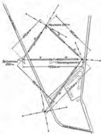
Bild 37. Schematische Darstellung der Mast- und Antennenanlage für Senderhaus 3.
