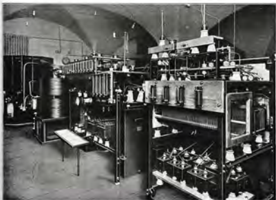
ESM 19. Rückansicht des dritten 10 kW Telefunken-Röhrensenders im Senderhaus I.
