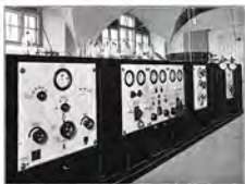
Bild 18. Dritter 10 kW Telefunken-Röhrensender im Senderhaus I, Vorderansicht.
