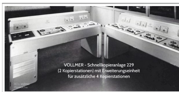
VOLLMER - Schnellkopieranlagen für 1/4"-Band VOLLMER-M10 als Mutter- und Laufwerk 120/141 als Tochtermaschine(n) Foto Nr. 25 >> © I. Vollmer, Privataarchiv << Foto Nr. 26
