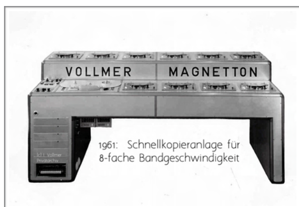
VOLLMER - Schnellkopieranlagen für 1/4"-Band VOLLMER-M10 als Mutter- und Laufwerk 120/141 als Tochtermaschine(n) Foto Nr. 25 >> © I. Vollmer, Privataarchiv << Foto Nr. 26
