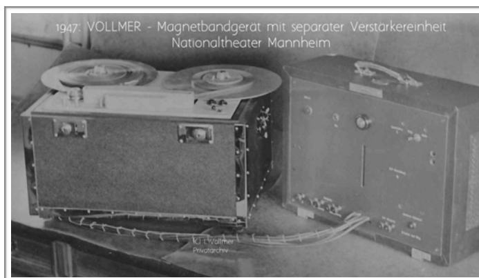
M1-Sonderanfertigung mit separater Verstärkereinheit Nationaltheater Mannheim - Foto Nr. 5 © I. Vollmer
